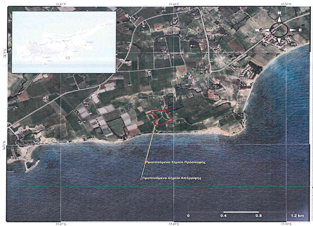
Εικόνα 3: Η εγκεκριμένη όδευση των υποθαλάσσιων αγωγών πρόσληψης (Lat: 34.773478°, Lon: 33.484329°) θαλάσσιου νερού και απόρριψη της άλμης (Lat: 34.771426°, Lon: 33.483910°)
